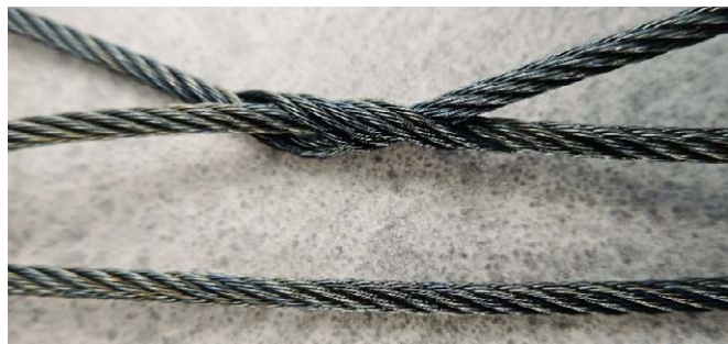
Photo 2: Les détails de surface sont conservés, du fait que les pièces à traiter par coloration spectrale ne sont pas revêtues.
